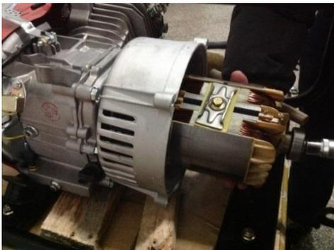
图 2.4 传统汽油机的单相同步发电机
