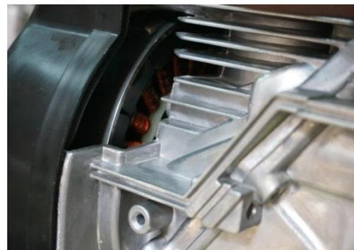
图 2.5 数码发电机的三相同步发电机
